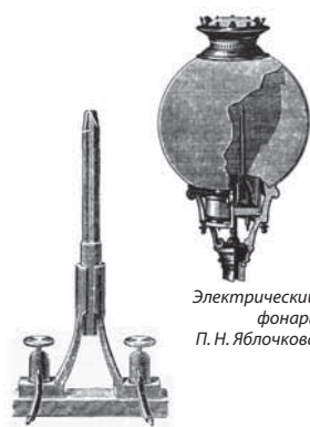
Устройство «свечи П. Н. Яблочкова»
